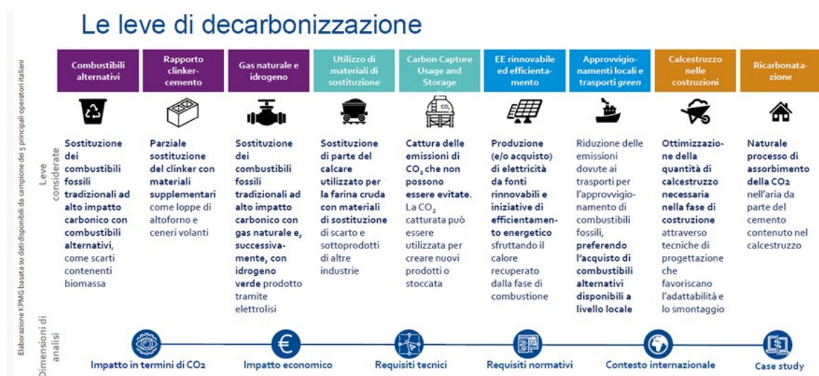
Figura 19 - Le leve di decarbonizzazione per la filiera del cemento (Fonte: Federbeton, 2020)
